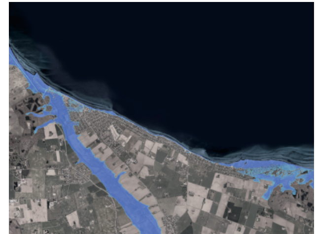
Strøby Egede og Strøby Ladeplads - Visualisering af vandstand i kote 2,80 m. Den viste vandstand svarer til vandstanden for 1872-stormen.
