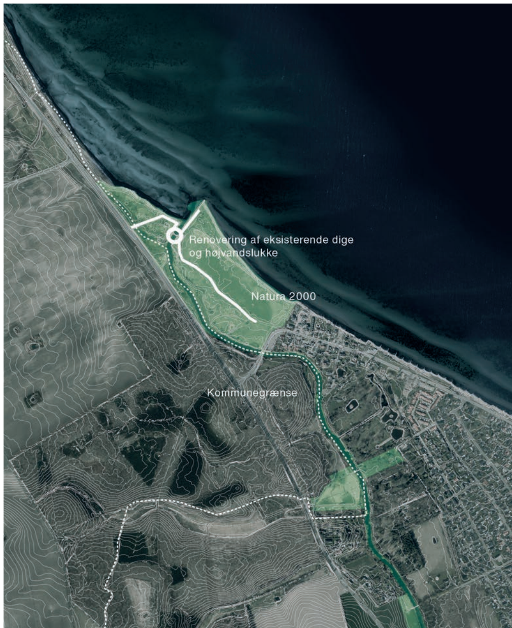
Kortet viser dige og højvandslukke på Odden, som Stevns Kommune vedligeholder til kote 2,5 m DVR90
